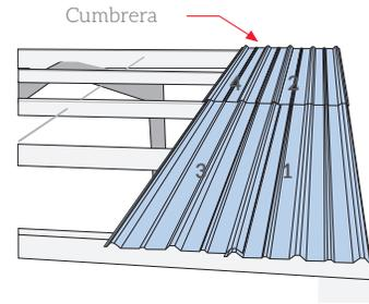
**3. Medición y corte de las tejas:** Mida la distancia entre las correas de la estructura y corte las Tejas de Policarbonato a la longitud adecuada. Asegúrese de que los posibles traslapos coincidan con un elemento de apoyo; así mismo, asegúrese de dejar un espacio entre la zona perimetral del área a cubrir y los elementos adyacentes, tales como mampostería, vigas, drenaje, entre otros, de manera que permita la expansión y contracción de las tejas.
