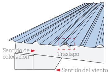
Para cubiertas donde sea necesario el uso de traslapos, instale primero las tejas de la parte inferior de la vertiente y continúe hacia la cumbrera.
