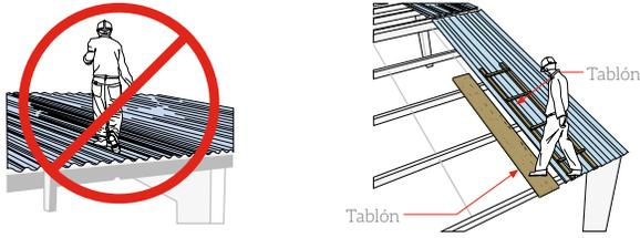
**Nunca camine directamente sobre la cubierta.** Use caminadores o estructuras que transmitan a los apoyos o correas, las cargas que se originen en labores de montaje o de mantenimiento.
