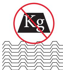
La superficie en la que se almacenen las Tejas de Policarbonato Ajover debe ser plana y no debe tener ninguna irregularidad que afecte la teja.
